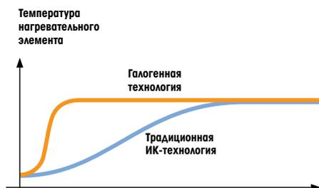
Анализаторы OHAUS MB25 с галогенным нагревом работают на 40% быстрее, чем анализаторы MB23 с традиционным инфракрасным методом нагрева.
